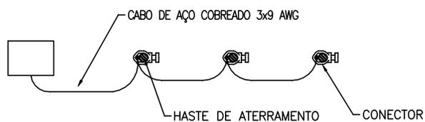
DETALHE 2 – CONEXÃO DO SISTEMA DE ATERRAMENTO PARA RDU
